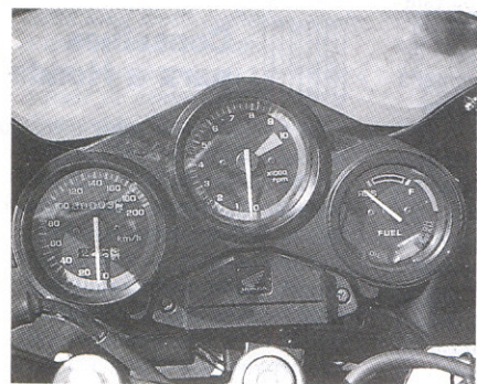
Painéis: nível de combustível na CBR...
